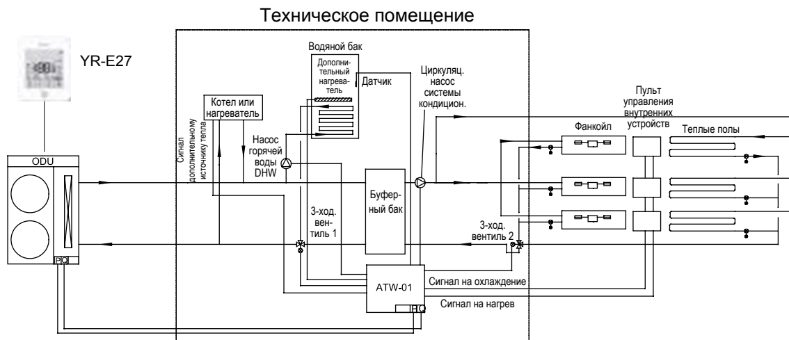
Рис.1 Производство горячей воды для бытовых нужд (DHW) под управлением YR-E27
